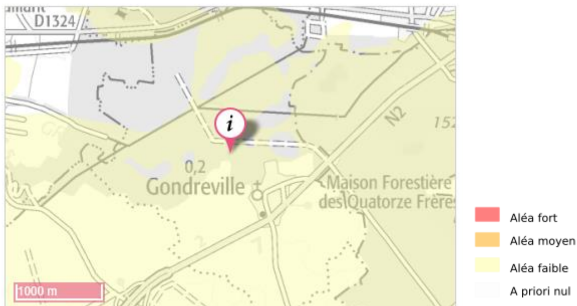
Figure 27: Risques liés au retrait et gonflement des sols argileux
