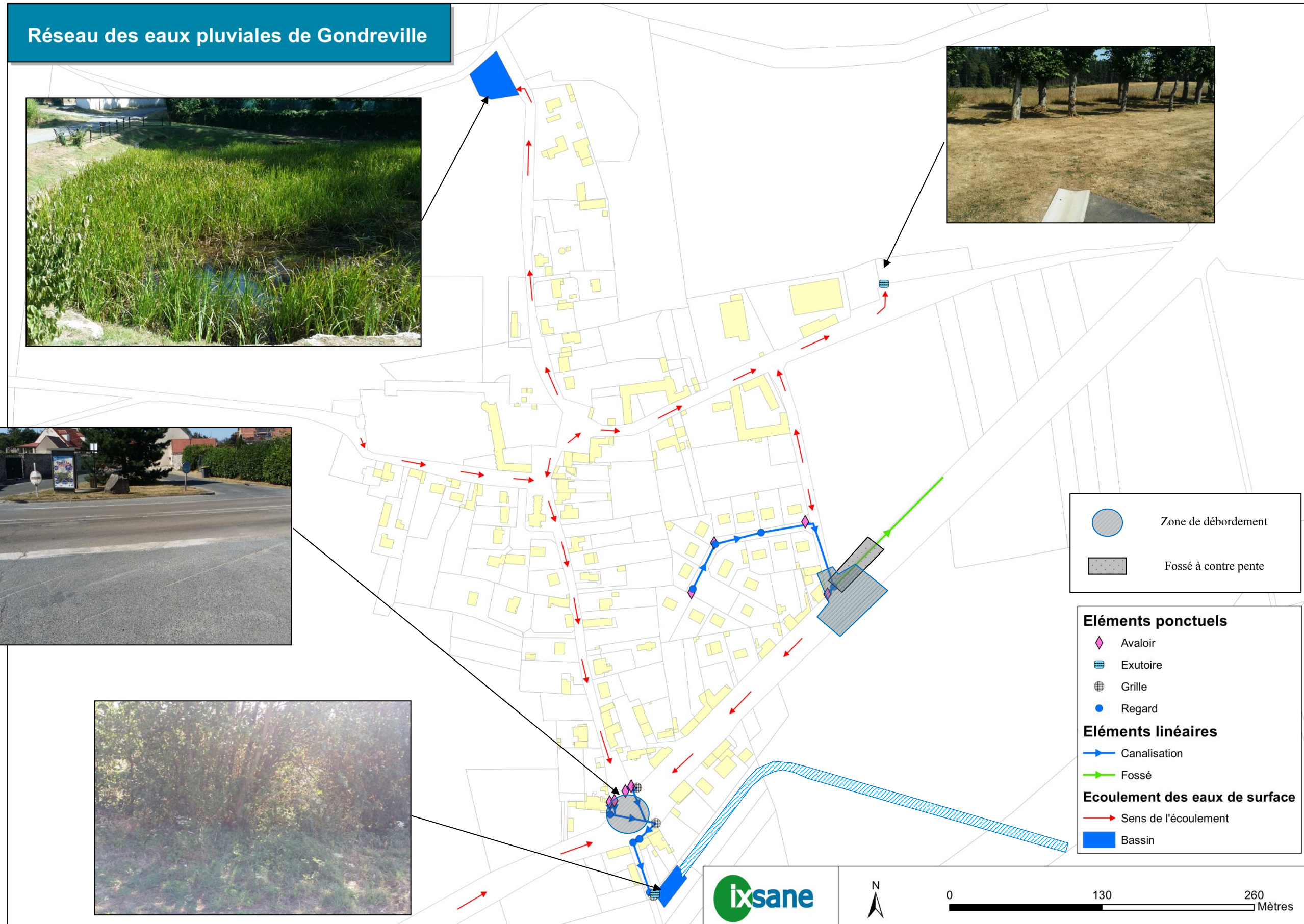
Figure 25: Localisation des dysfonctionnements rencontrés lors d'événements pluvieux
